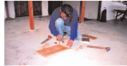
Fotoğraf 78: Tornet oyunu: Rulmanları takılmış takozun tahtanın arkasına çakılması.
