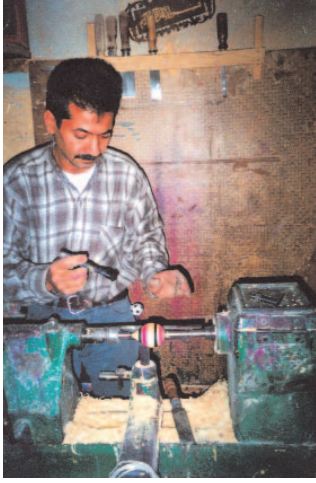
Fotoğraf 97: Topaç Çevirmece oyunu: Torna makinesine yerleştirilen topaç, el sabit tutularak boyanır.
