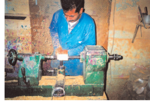
Fotoğraf 95: Topaç Çevirme oyunu: Dönen çam dalına, ucu düz demir çubuk temas ettirilerek şekil verme işlemine başlanılır.
